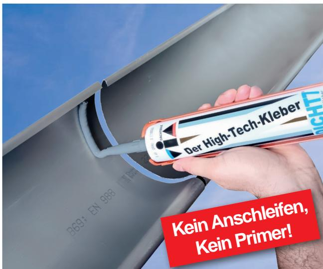
Der Auftrag des Klebers **VIA-DICHT7** erfolgt in einem Abstand von  $\geq 25$  mm zum Rinnenende. Die Kleberaube mit einem Durchmesser von  $\geq 10$  mm wird auf ganzer Länge der unteren Verbindungsfläche auf der Rinneninnenseite aufgetragen. Verarbeitungs-/Oberflächentemp.  $+5^{\circ}\text{C}$  bis  $+40^{\circ}\text{C}$ .
