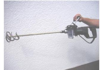
**Hinweis:** Kein Freifallmischer oder Zement-/Betonmischer verwenden.
